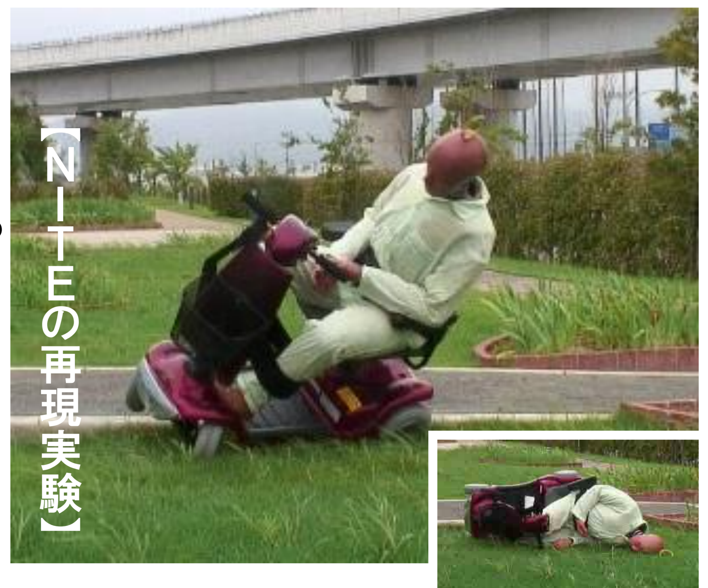
路肩から脱輪して転倒しました
